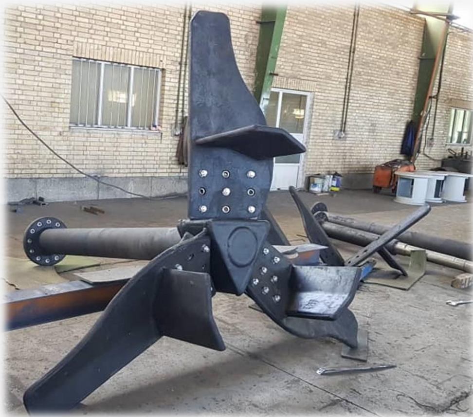
همزن آبیگری باطله فاز ۲ گل گهر ۷۵ کیلو وات ابعاد تانک: قطر ۹.۲ ارتفاع ۱۰.۷ متر
